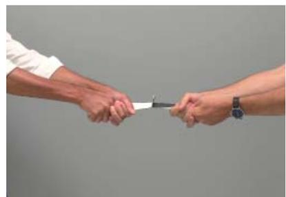
Ensayo de pelado de la soldadura con resultados más de 3 veces mayores que el EPDM, para solapess impermeables de larga duración.
