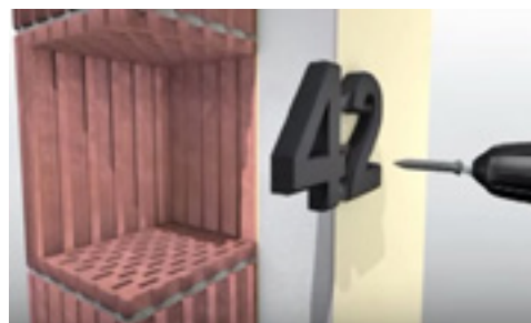
4. Tornillo tirafondo adecuado al taco espiral ( \varnothing entre 4-5 mm)
